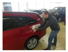
wird, steckt viel Arbeit. Nach der Bestellung und der Auslieferung müssen sie speziell für stadtmobil "eingerichtet" werden. Dazu gehört zum Beispiel der Einbau der Bordcomputer und die Beklebung mit dem stadtmobil Logo und der Telefonnummer der Buchungszentrale.
